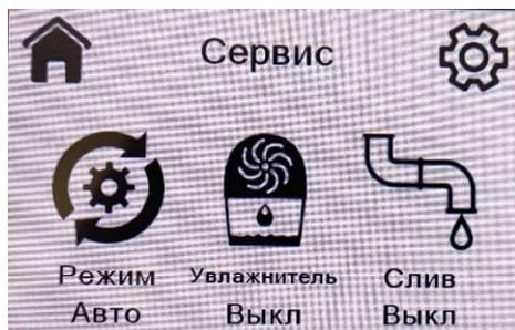
При возникновении ошибок они будут отображаться в соответствующем меню (! знак в левом верхнем углу главного экрана пульта) и подсвечены красным цветом. Работа увлажнителя будет приостановлена до их устранения и сброса. При нажатии на ошибку, откроется подменю с кнопкой «СБРОС».
