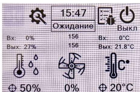
В настройках на пульте увлажнителя (шестеренка с ключом) необходимо проконтролировать, чтобы увлажнитель находился в автоматическом режиме работы, слив был **выключен**.
